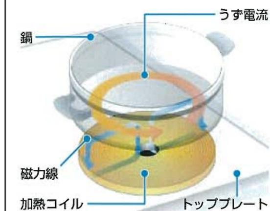
コイルに電流を流すと磁力線が発生します。この磁力線の中に鍋を置くと、鍋にうず電流が発生し、鍋の電気抵抗によって鍋自体が発熱します。
