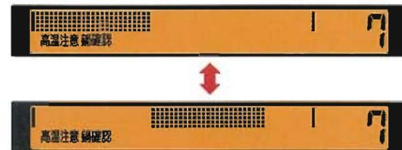
※表示窓の液晶表示が赤く点灯し、「鍋確認」を表示します。
