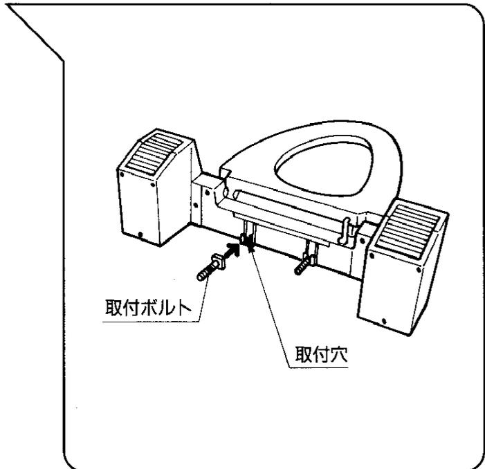
2. 便器の取付穴に取付ボルトを差込み、便器の下側から取付ボルトに三角パッキンを入れ、ナットで仮止めしてください。
