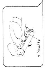
5.シートペーパーの先端を便座中央付近までまっすぐ引出してください。 次にシートベーパーを軽く張った状態でスイングフレームを元の位置に戻し、カチッと音
