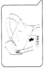
7.操作スイッチを押して1回使用分のジートペーパーが便座上に出てくることを確認してください。 確認後は再度、操作スイッチを押してから、ジートペーパーを取除いてください。
