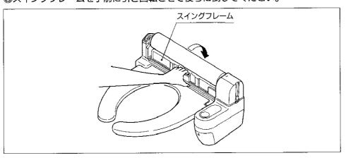
④シートペーパーの先端を便座中央付近までまっすぐ引出してください。シートペーパーを軽く張った状態でスイングフレームを元の位置に戻し、カチッと音がするまで押込んでください。
