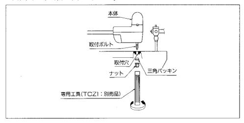
③本体を前後左右に動かして便器との取合い位置を調整してからナットをマイザレット本体ががたつかないように専用工具(TCZ1:別売品)で確実に締付けてください。
