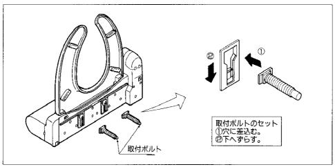
②便器の取付穴に取付ボルトを差込み、便器の下から取付ボルトに三角パッキンを 入れ、ナットで仮止めしてください。
