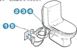
止水栓を閉める(水抜栓のときは開 ける)
