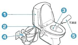
1 ロータンクと配管の水を抜く
