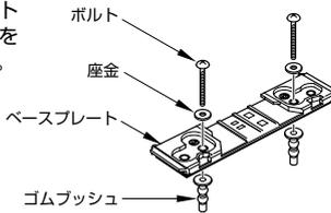
3 ゴムブッシュを便器取付穴に差し込み、上面からドライバーでボルトをかるく締めしておく。
