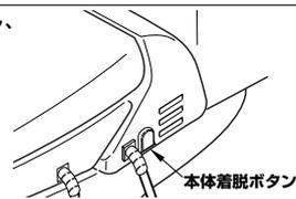
6 ベースプレートが便器にあたるまでボルトをしっかりと締めた後、再び本体を「カチッ」と音がするまで押し込む。
