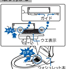
● フィルターの「ウ」表示を上にしてウォシュレットのガイドに合わせ、「カチッ」と音がするまで確実に押し込む
