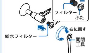
給水フィルターは確実に締める(確実に締めないと、水漏れの原因になります。)
