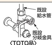
※このタイプの止水栓及び分岐金具の場合、既設給水管は取りはずさず、そのまま使用できます。
