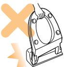
止水栓を開けたままで、給水フィルター付水抜栓をはずさない
