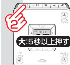
▶ ウォシュレットから「ピッ・ピッ」と2回鳴ると同時に本体表示部の「**運転**」ランプが2回点滅します。
