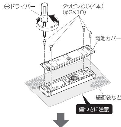
使い終わった電池を、指でコネクターから取りはずし、ハーネスの向きを確認し、指で新しい電池のコネクターを差し込む
