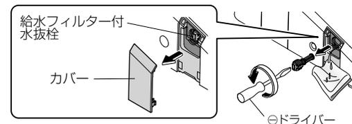
②水抜きが終わったら、給水フィルター付水抜栓・カバーを取り付ける
