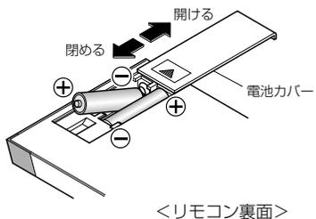
●乾電池を正しくセットすると、リモコンの全ランプが約2秒間点灯します。
