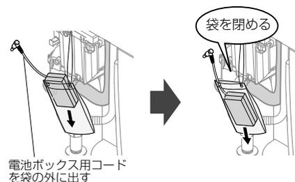
**5** 電池ボックス用コードを電池ボックス用プラグ差し込み口に取り付ける
