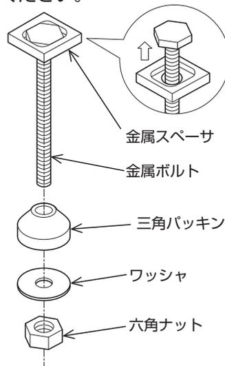
※六角ナットの締め付けは、市販の工具を使用してください。
