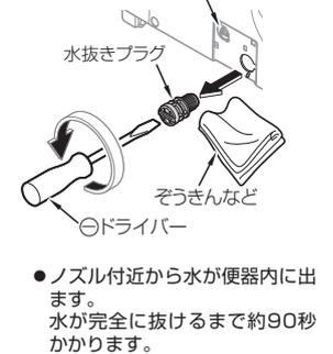
⑤ 水抜きプラグ、カバーを取り付ける
