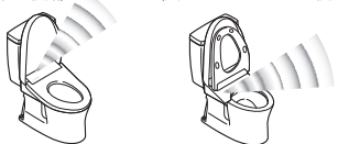
人体検知センサーA (熱の変化を検知)
