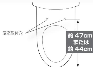
**2** ベースプレートのボルト一式を便座取付穴に押し込む（左右2カ所）
