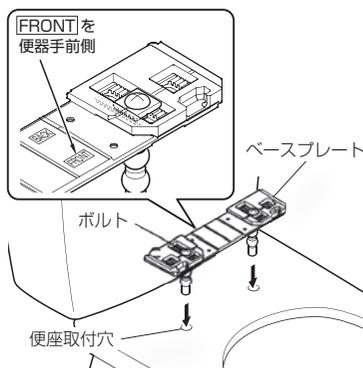
**3** ベースプレートのボルト取付位置を調整する
