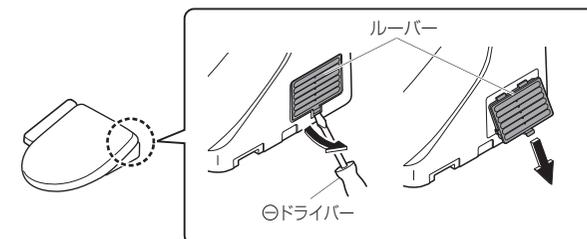
3 脱臭カートリッジを取りはずし、新しい脱臭カートリッジを取り付ける
