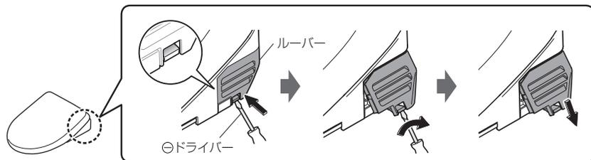
3 脱臭カートリッジを取りはずし、新しい脱臭カートリッジを取り付ける
