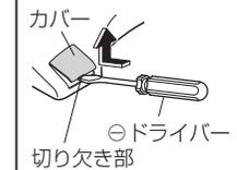
③給水フィルター付水抜栓をドライバーでゆるめて、引っ張る
