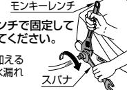
給水口をモンキーレンチで固定して給水ホースを接続してください。
