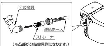
分岐金具に連結ホースをスパナで締め付ける
