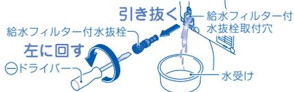
**注意** 止水栓を開けたままで、給水フィルター付水抜栓をはずさない
