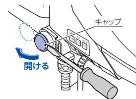
③ 給水フィルター付水抜栓を⊖ドライバーでゆるめた後、引っ張ってはずす
