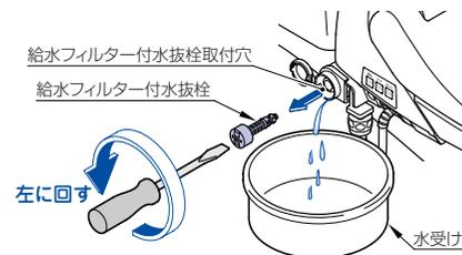
④ 給水ホースを水平にして、ホース内の水を抜く(約30ml)
