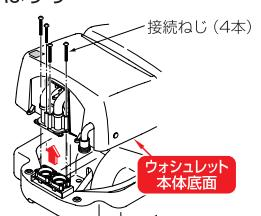
※凍結防止ヒータ付便器の場合：凍結防止ヒータ用コネクタをはずす
