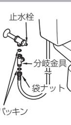
止水栓の先端で給水が分岐しているタイプから取り替える場合
