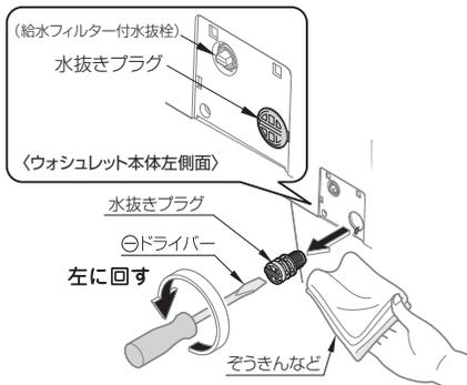
② 水抜きプラグを取り付ける
