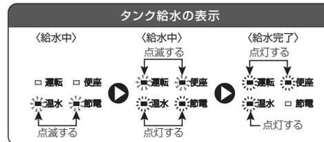
※タンク給水中に「ヒュー」という音がする場合は、給水圧が高くなっていますので、音が鳴らなくなるまで止水栓を少し右へ回してください。
