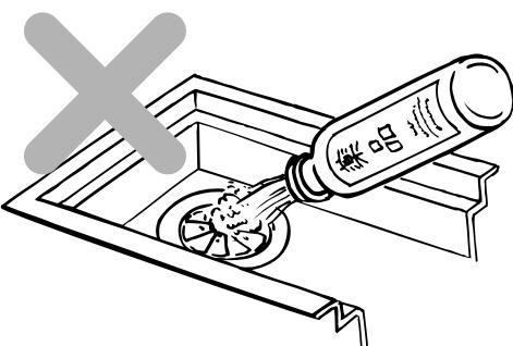
(2)トラップに溶剤・塗料・接着剤・薬品など（例えば写真現像液）を流したり付着させるとトラップが変形したり、侵されたりすることができますので流さないように十分注意してください。
