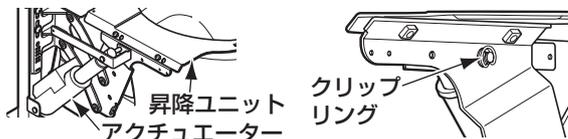
6. 昇降プレートを支えながらアクチュエーターピンを引き抜いて左右2つのアクチュエーターを外す。
