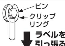
※ラベルがちぎれた場合は、ラジオペンチなどの工具を使用してクリップリングを外してください。
