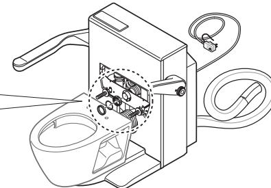
⑧便器を便器固定プレートから50mmのところまで近づけ、短管をスパッドの奥に突き当たるまで挿入し、袋ナットをスパナで締め付ける。
