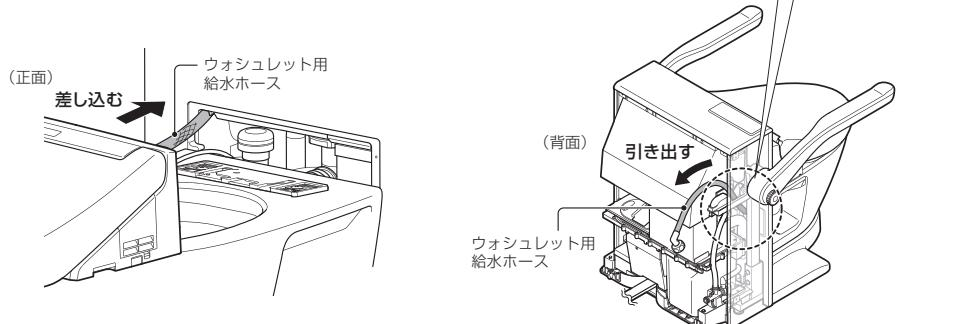
分岐付電磁弁に接続する
