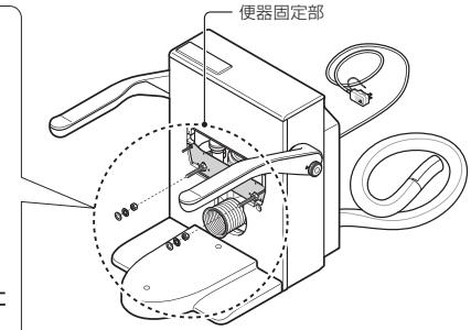
①同梱の便器固定用ナット、ワッシャー、平パッキンを便器固定用ボルトの先端から60mmのところを
