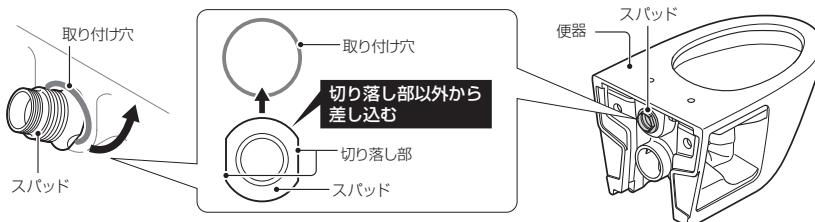
②スカートパッキンを取り付け穴に差し込み、スパッドに組み込む。
