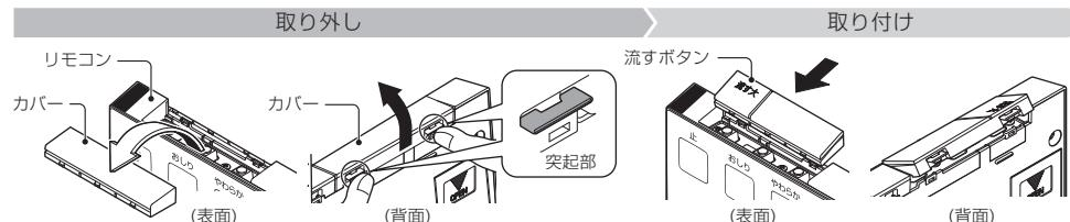
リモコン背面の突起部(2カ所)を同時に押してカバーを取り外す。
