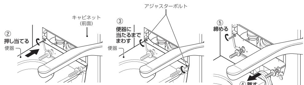
⑥排水フレキジョイントを便器に差し込み、マイナスドライバーを使いホースバンド(同梱品)で確実に
