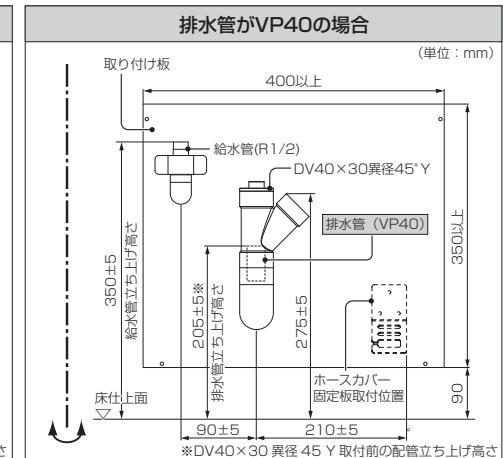
給水管、排水管、ホースカバーの位置関係は左右対象で設置が可能です。図は、配水管を右向きに設置した場合です。
