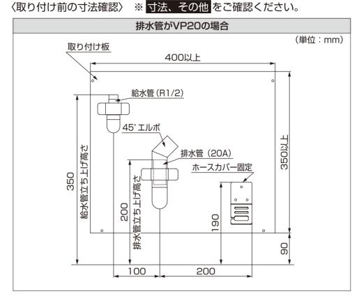
チェック② 給水管のねじ(金属R1/2)と位置 配管部品の位置・寸法や向きは、ホースカバーの固定 位置によって左右対称になります。
