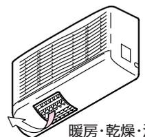
(2) 換気 「浴室」の「換気」ボタンを押して室内機本体の吸込口から換気していることを確認してください。このとき液晶には「換気」が表示されます。「止」ボタンを押して停止を確認してください。
