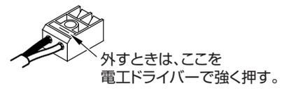
③アース線（現場手配）を接続し、電源線、アース線をクランプで固定します。
