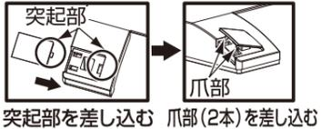
突起部を差し込む 爪部(2本)を差し込む
