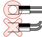
・電線を外すときはここを電工ドライバーで強く押ししてください。
