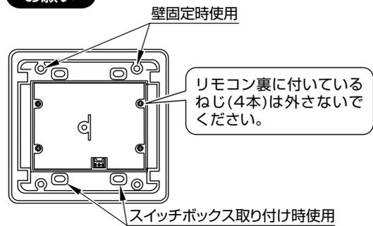
・スイッチボックスに取り付ける場合は、取付ねじを締めすぎないようにしてください。下ケースが変形して上ケースがうまく入らなくなるおそれがあります。
