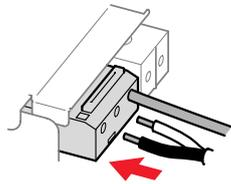
・端子台の近くで大きく曲げると先端が十分に差し込まれない場合があります。
