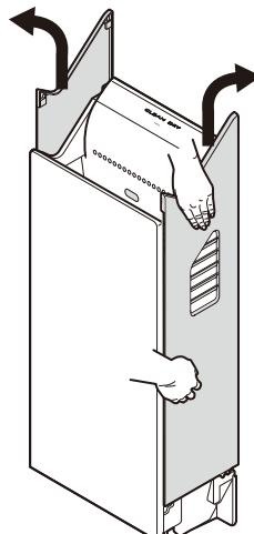
側面カバーの上端を持って上に引き上げながら外向きに外してください。
