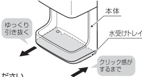
●水受けトレイを引き抜く際は、確実につかんで水平に引き抜いてください。水のたまった水受けトレイが落下したり、中の水がこぼれる原因になります。
