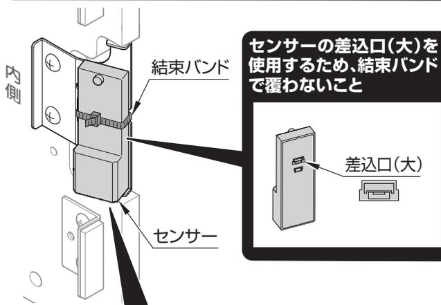
**センサーと取付材(センサー)が接触していること**
