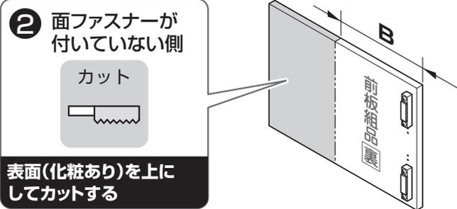
測定寸法A  $-5\text{mm} =$  けがき寸法B
