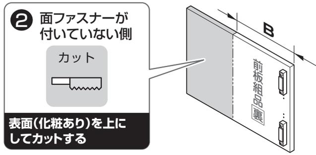
測定寸法A  $-5\text{mm} =$  けがき寸法B
