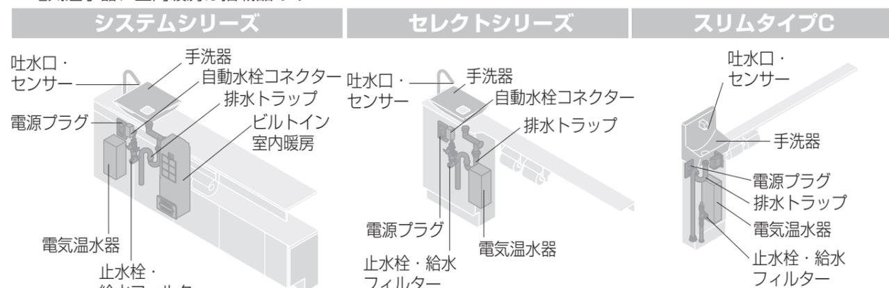
※仕様によりハンドル式水栓の止水栓は底板の下にあります。(P.11参照)
