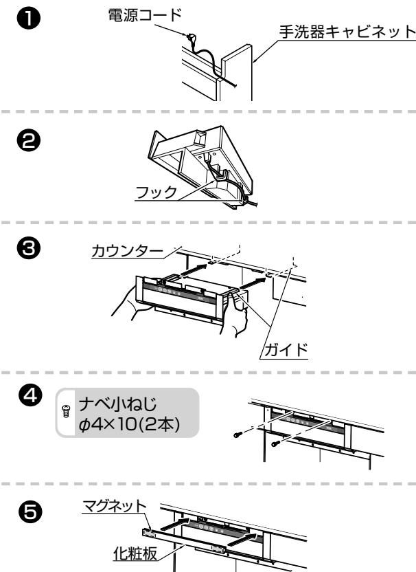
**11 ビルトインリモコン****12 手洗器・水栓金具****13 給排水**
