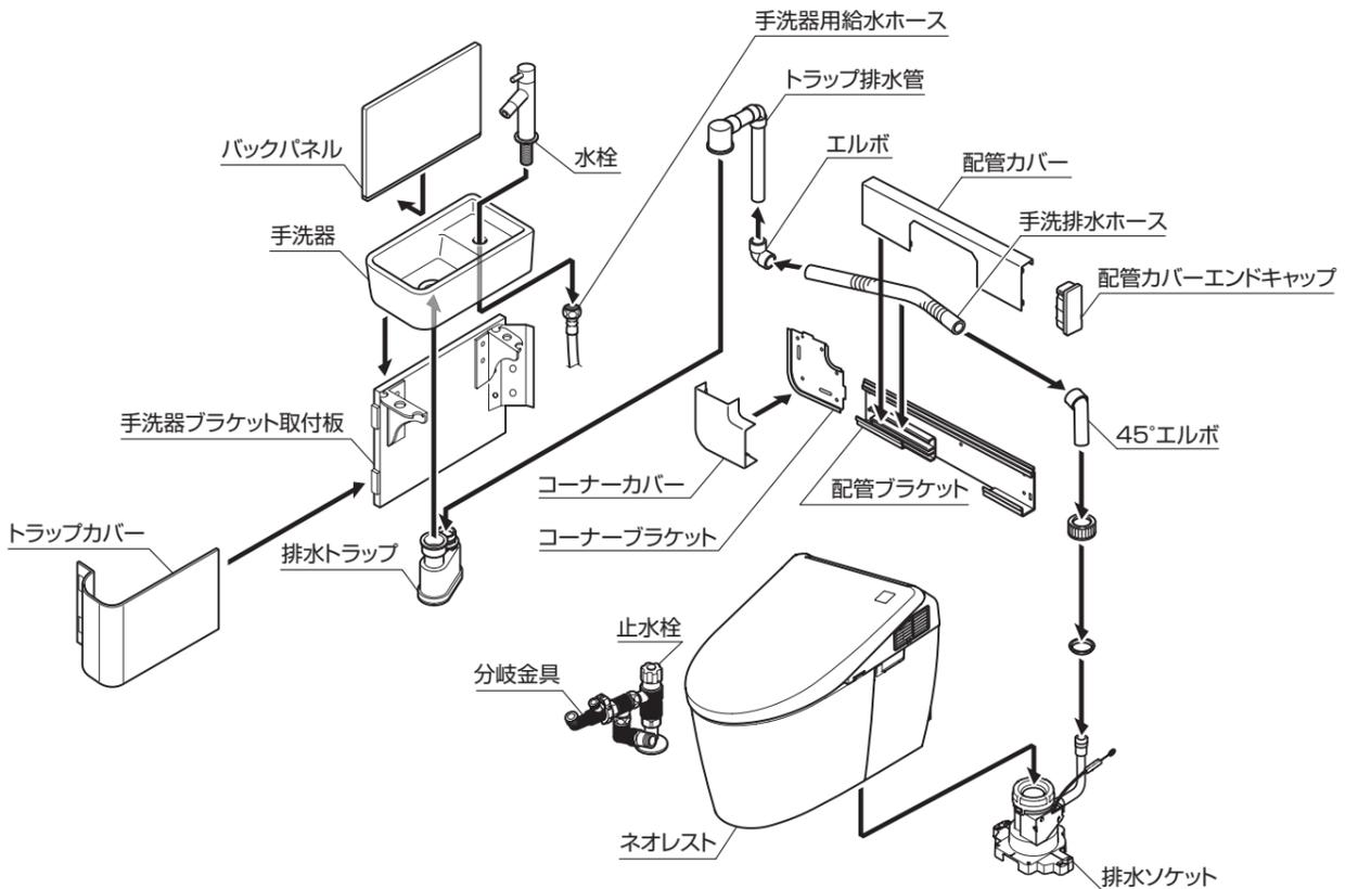
※止水栓は必ず製品同梱の専用止水栓 (フィルター付き) を取り付けてください。
