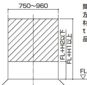
間柱および受木がない場合は、左図の斜線範囲(壁裏)(周辺部材を設置する場合は取付面)にt12以上の合板(JAS規格相当品)を入れてください。
