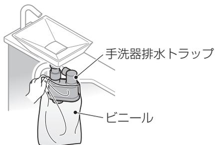
③ ビニールの外から手洗器排水トラップ下の掃除口キャップをゆるめる
