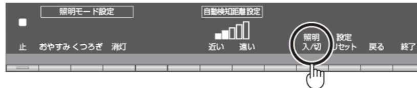
照明設定画面の“照明入／切”ボタンでタイマー設定時間と関係なく照明の使う／使わないの設定ができます
