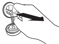
□リングを引いて、タンク内の排水弁が引き上がることを確認する
