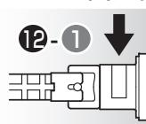
□レバーを「大」側に回して、排水弁のみが引き上がるることを確認してから、カバー(A)を付ける
