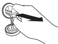
リングを引いて、タンク内の排水弁が引き上がるかを確認する
