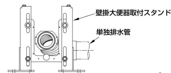
2. 排水ソケットを幕板の上部開放部から挿入し、幕板をスタンド本体に固定します。
