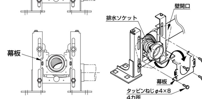
3. 排水ソケット前面からソケット押え板をかぶせて幕板にビス固定します。
