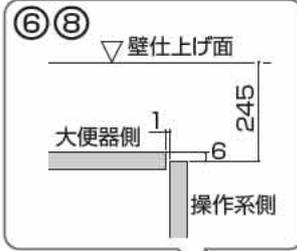
① 壁仕上げ面から、245mm程度離して①の前板を取り付ける
