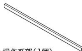
操作系部(1個) (洗面器ありの場合：932mm) (洗面器なしの場合：934mm)
