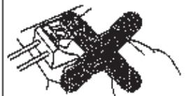
通電中は電源端子台には絶対に手を触れないでください。感電の原因となります。
