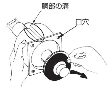
8. 排水弁胸部の溝を便器正面方向に向け、排水弁の口穴とツメ位置をあわせながら排水弁に押し込んで取り付ける。
