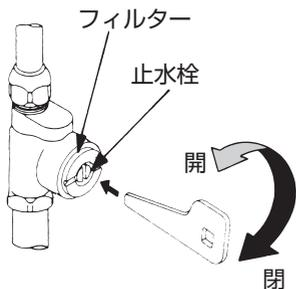
**フィルター開閉工具で右に止まるまで回して、止水栓を閉める。**
