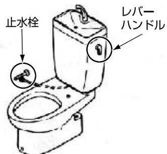
1. 止水栓を閉めてから(マイナスドライバーで右に回します)、タンク内の水を流してください。
