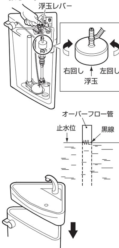
3. 浮玉レバーの根元を手で押さえて浮玉を回して止水位を調整する。(回す方向は上から見たものです)
