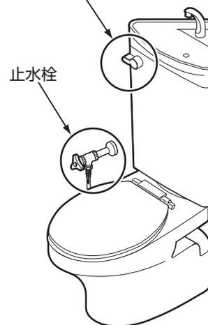
1. 止水栓を閉めてから（ハンドルを右に止まるまで回す）、タンク内の水を流す。流したあと、タンク内に給水されていないことを確認する。
